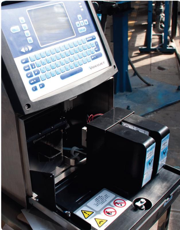
O sistema de entrega de fluido Smart Cartridge™ na nova codificadora Videojet 1710 da Baosheng
